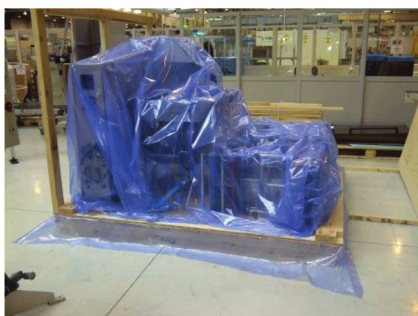
3. Zabezpieczenie elementów folią antykorozyjną
