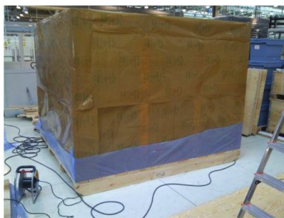
6. Zabezpieczenie warstwą papieru antykorozyjnego
