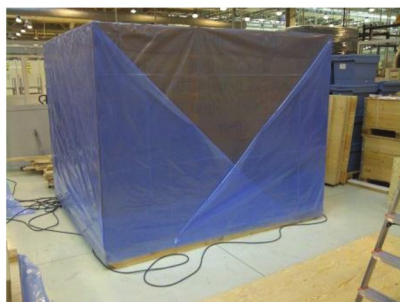
7. Zabezpieczenie warstwą folii antykorozyjnej
