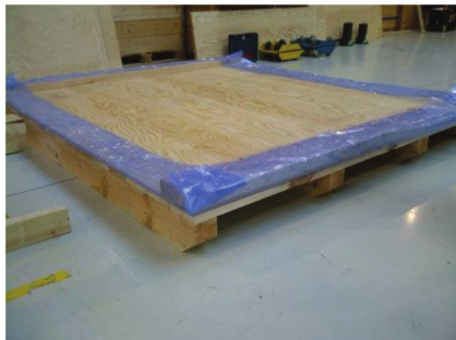
1. Platforma – podstawa z drewna fumigowanego, sklejki wodoodpornej i folii antykorozyjnej
