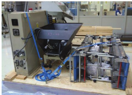
2. Zabezpieczenie elementów na platformie
